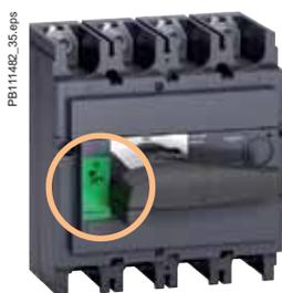
Un sistema meccanico assicura che la posizione della leva di manovra rifletta sempre la posizione dei contatti principali. Con la visualizzazione del sezionamento, Schneider Electric garantisce la massima sicurezza a tutti gli utenti della gamma Compact INS.
