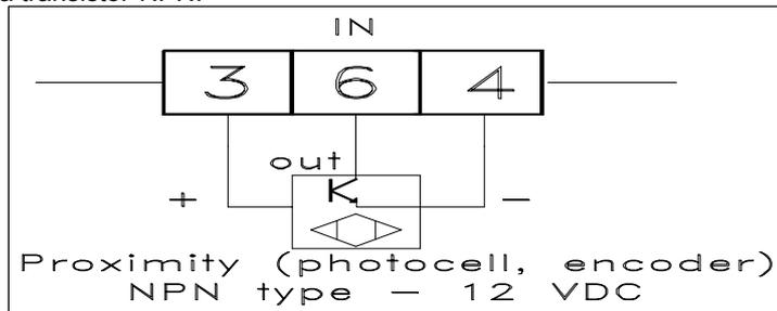
In funzione della frequenza del segnale fornito all'ingresso CNT è consigliabile impostare il filtro software del par. "H" che permette di selezionare la massima frequenza di ingresso accettabile per il conteggio ed evitare così conteggi indesiderati (causati ad esempio dai rimbalzi dei contatti).
