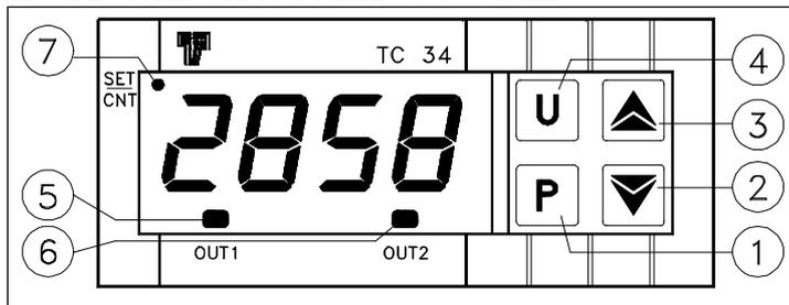
**1 - Tasto P** : Utilizzato per l'impostazione dei set point e per la programmazione dei parametri di funzionamento
