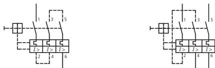
**Protezione di cavi con isolamento in PVC contro sovraccarichi termici in caso di corto circuito**
