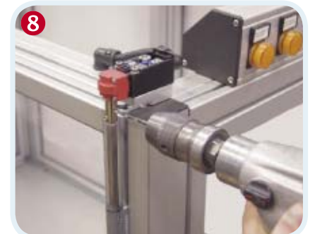
8 Forare l'albero cerniera tramite uno dei 2 fori presenti nell'albero dell'interruttore.
