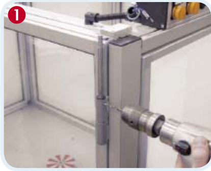
1 Forare la cerniera e il perno.
