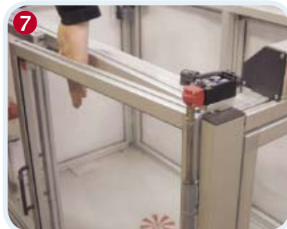
7 Verificare il punto d'intervento secondo EN 294, se necessario ricalibrare il punto d'intervento (vedi fig. 6).
