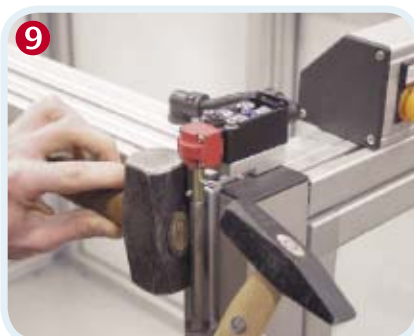
9 Spinare l'interruttore (spina in dotazione).
