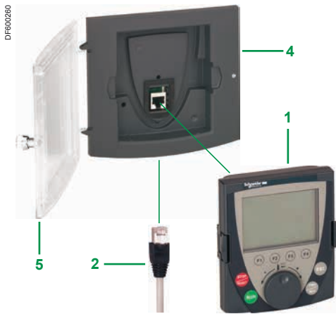
Terminale grafico montato su porta di armadio: 1 + 2 + 4 (+ 5, con IP 65)
